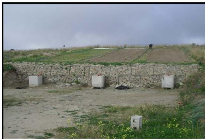
Figura 5 – Impianto sperimentale per lo studio dei processi di ruscellamento ed erosione a scala di parcella (Facoltà di Agraria, Gallina di Reggio Calabria)
