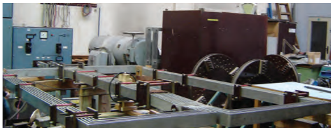
Obr. 7: Proudová smyčka s kalibrovanou RC
