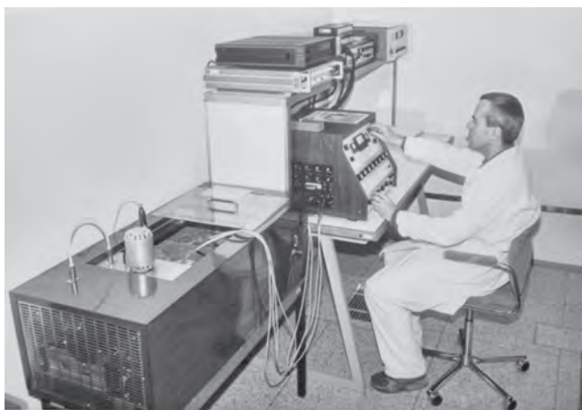
Obr. 3: První proudový komparátor GUILDLINE 9975 s příslušenstvím (Kanada), první olejový termostat MEATEST M 301 s uloženými etalony odporu a první pracovník ČMI v primární laboratoři v roce 1994.
