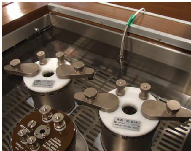
Obr. 4: Dva etalony odporu 1 Ω výrobce CSIRO-NML (později budou členy státního etalonu) v olejovém termostatu spolu s etalonem odporu výrobce Tinsley.
