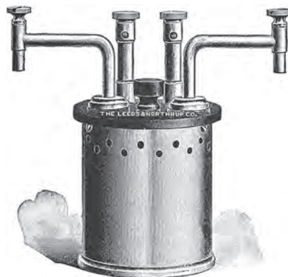
Obr. 2: Etalon odporu 1 Ω, výrobce Leeds & Northrup, z přelomu 19. a 20. století [1]
