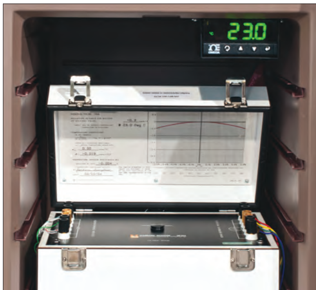
Obr. 5: Etalon odporu 10 kΩ výrobce ESI, typ SR 104 - 10 kΩ (pozdější člen státního etalonu) ve vzduchovém termostatu MI 9300.
