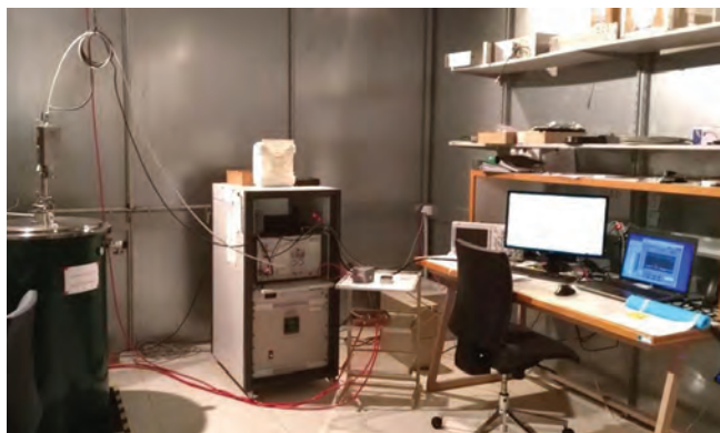
Obr. 10: Systém CCC-1 MAGNICON v kvantové laboratoři. Vlevo kryogenní vložka CCC v kryostatu CRYOGENIC, uprostřed řídicí elektronika, vpravo řídicí počítač s osciloskopem pro sledování signálu SQUIDu.
