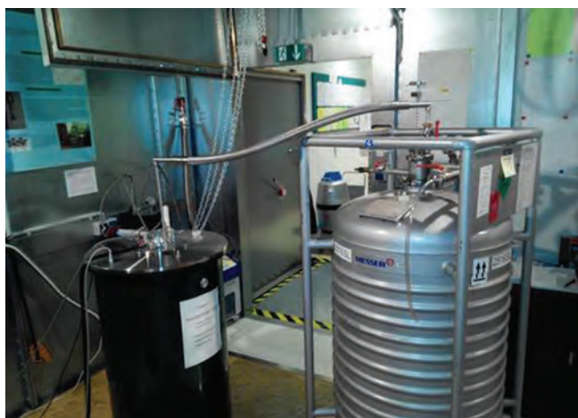
Obr. 9: Kryostat se supravodivým magnetem pro realizaci pracovních podmínek KHJ (vlevo), plněný tekutým héliem z Dewarovy nádoby (vpravo) v nových prostorách laboratoře - stíněné komoře.
