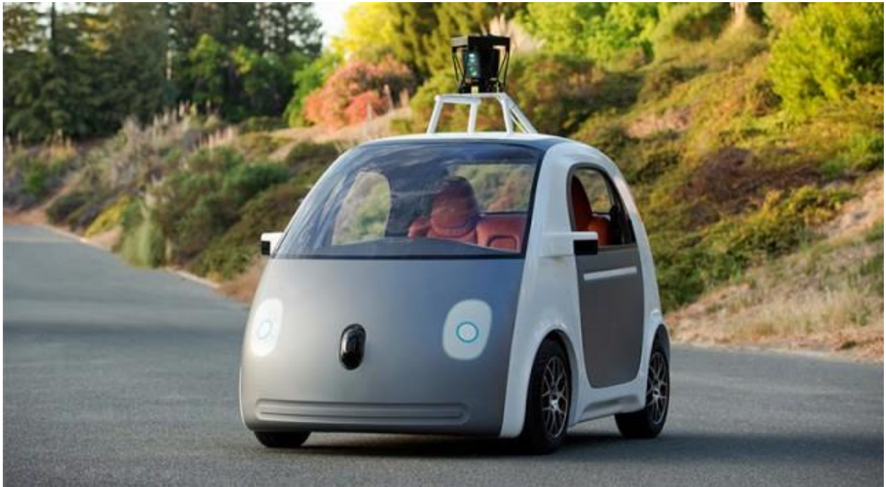
Фиг. 1. Първи прототип на Google самостоятелен автомобил, почти изцяло създаден от пластмаса, с електрически двигател, с ограничение от 40 км в час, без волан
