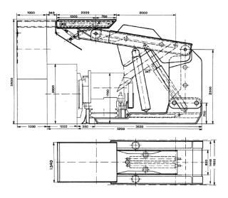
Fig. 2. The VHP750 sublevel caving shield
