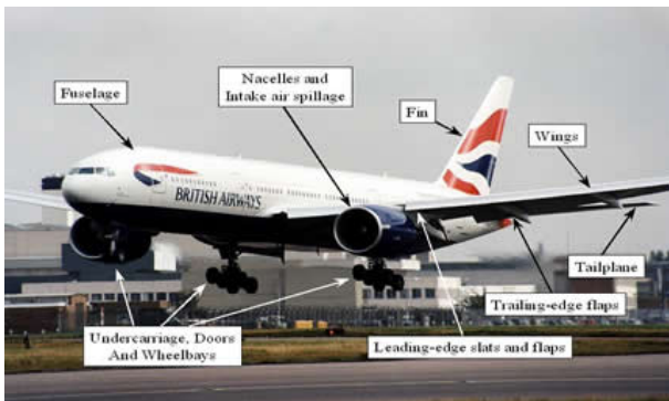
Figura: Principales fuentes de ruido en un avión comercial.
