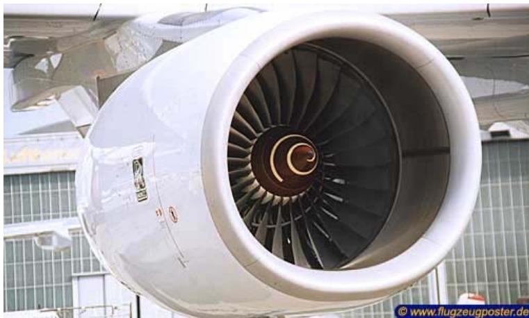
Figura: Motor de aviación tipo turbofan.
