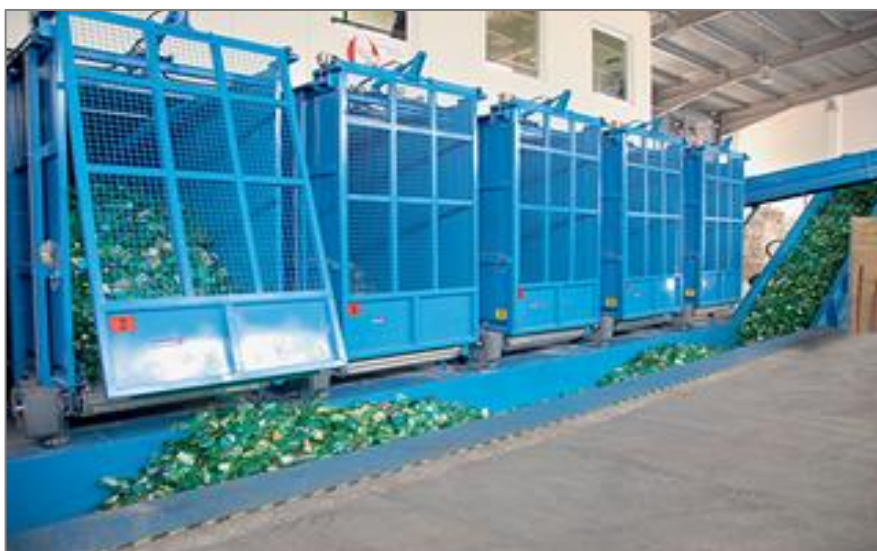
Obrázek 2.: Ukázka vybavení dotřídovací linky – kóje s vyklápěcími vraty, dopravník k lisu
