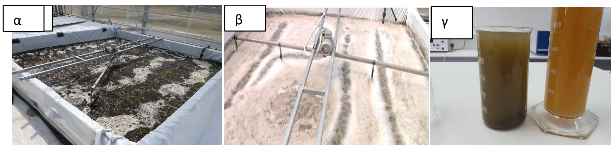
Εικόνα 2(α),(β) Ετεροτροφική καλλιέργεια μικροφύκους Schizochytrium limacinum SR 21 στους πιλοτικούς βιοαντιδραστήρες στις θερμοκηπιακές εγκαταστάσεις του Πανεπιστημίου Θεσσαλίας στο Βελεστίνο σε θρεπτικό διάλυμα που περιέχει ακατέργαστη γλυκερόλη και εκροές από παραγωγή βιοαερίου από γεωργοκτηνοτροφικά υπολείμματα και (γ) νωπή βιομάζα του μικροφύκους Schizochytrium limacinum που συλλέχθηκε μετά από φυγοκέντριση.
