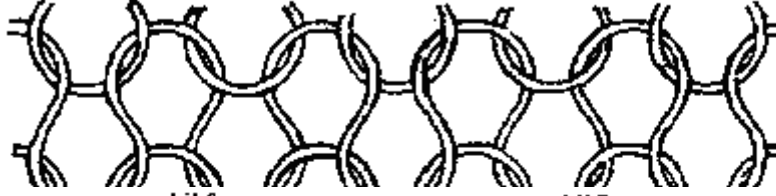
şekil 6 1 düz x 1 ters kıvrımlı düz yüz
