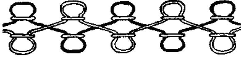
şekil 10 interlock (sıkı örgü) ön yüzü
