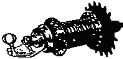
Pedalin geriye çevrilmesiyle çalışan kontrapedallı frenler
