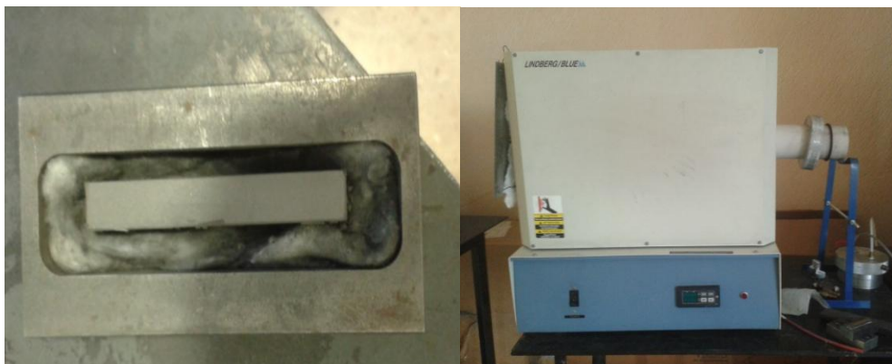
Figura B 1.2 Preformados sinterizados en horno tubular.
