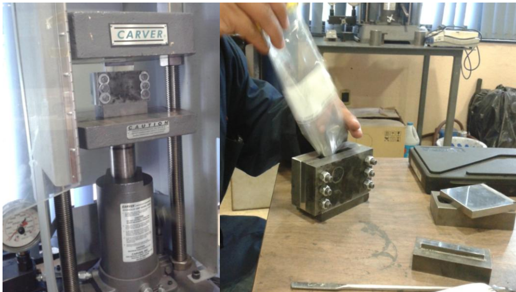
Figura B 1.1 Preparación del preformado poroso para sinterización.
