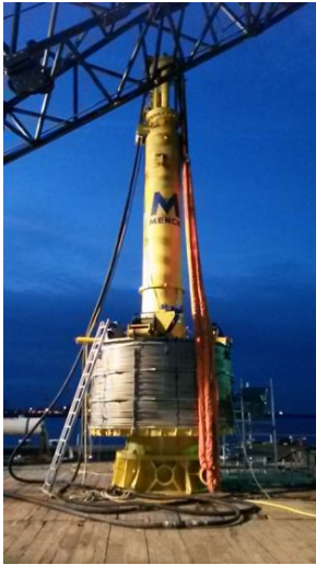
Abbildung 18: Ausrüstung einer Schlagramme mit Faltenbalg
