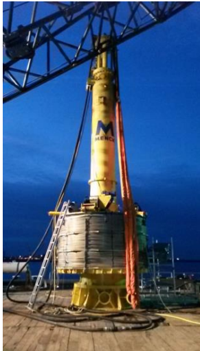
Abbildung 13: Ausrüstung einer Schlagramme mit Faltenbalg
