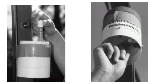
Figure 1 : Illustration de l'installation des tubes passifs de NO 2
