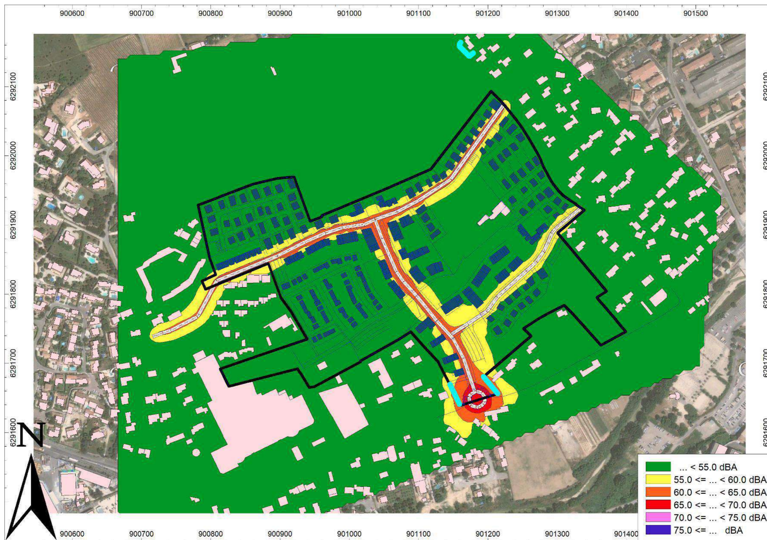
Carte de bruit - Etat futur avec écrans acoustiques H = 2m - Période diurne - Horizon 2041
