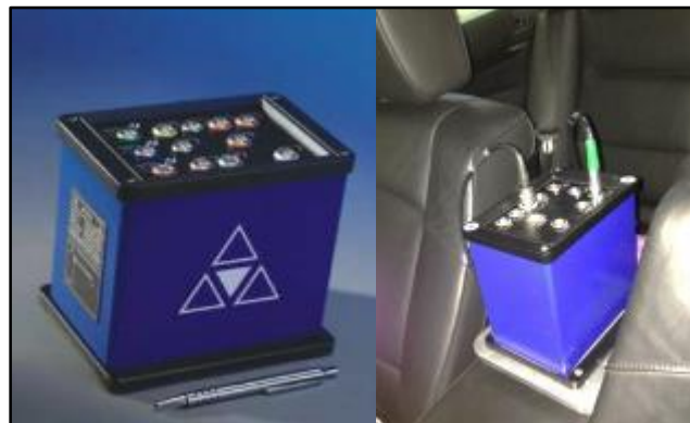
Abbildung 37: Produktfoto [GeneSys, 2015] und der eingebaute ADMA-G im Messfahrzeug
