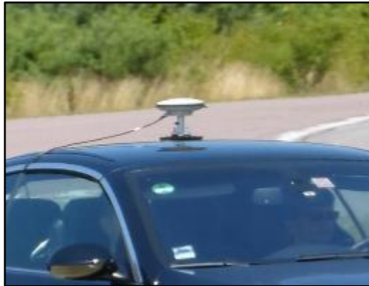
Abbildung 38: Der GPS-Empfänger auf dem Dach des Messfahrzeuges
