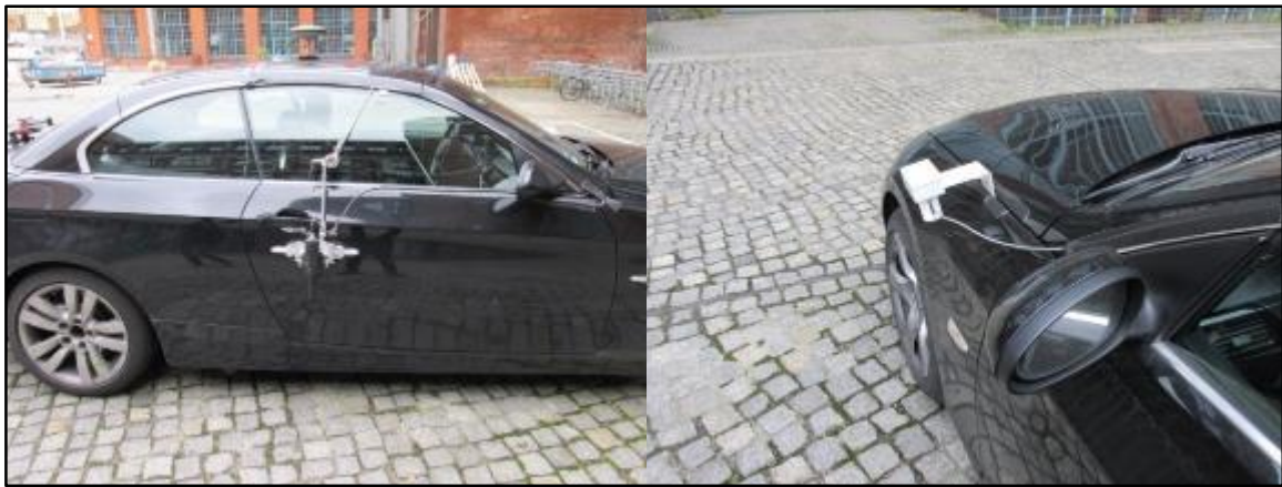
Abbildung 40: Anbauvariante der „Vaisala DSP 211“ Messeinheiten
