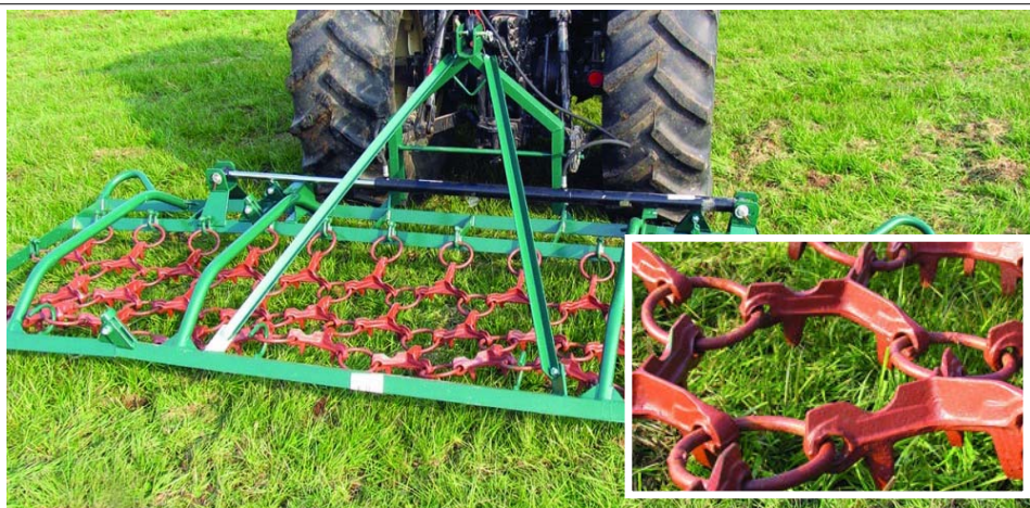
Strigliatrice. Utilizzata sia per arieggiare i prati sia per rompere il letame distribuito.
