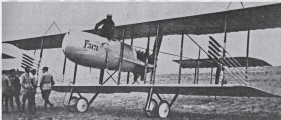
Letoun Farman HF-40, vyzbrojený raketovými střelami Le Prieura za první světové války
