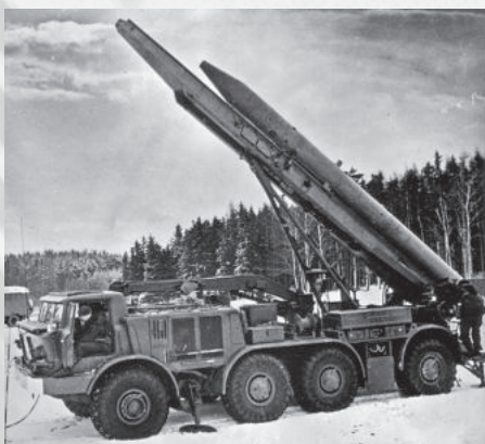
Od roku 1966 se dodávaly i modernější verze raket 3R-11 Luna M s doletem 70 kilometrů, odpalované z vozidel ZIL-135
