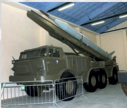
3R-11 Luna M (FROG 7) s cvičnou hlavicí a kolovým podvozkem ZIL-135 (9P113) v Lešanech
