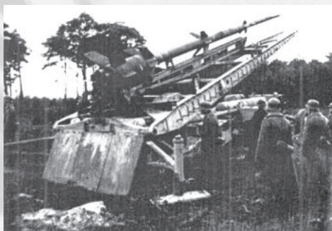
Čtyřstupňová operační střela V-4, známá pod bojovým jménem Rheinbote
