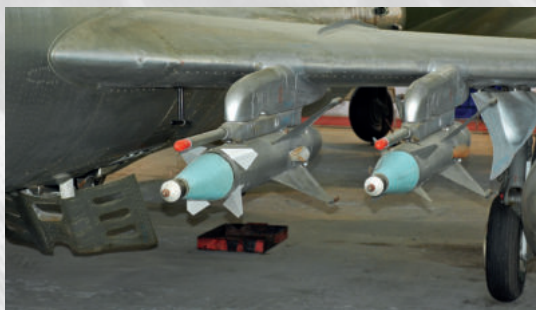
Dvojice sovětských raket RS-2U (AA-1 Alkali). Radarem řízené protiletectvé rakety používalo československé letectvo od počátku šedesátých let na letounech MiG-17PFM a MiG-19PM
