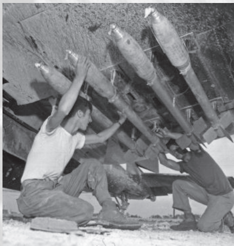
Americké neřízené letecké rakety ráže 127 mm, připravované k útoku na Okinawu
