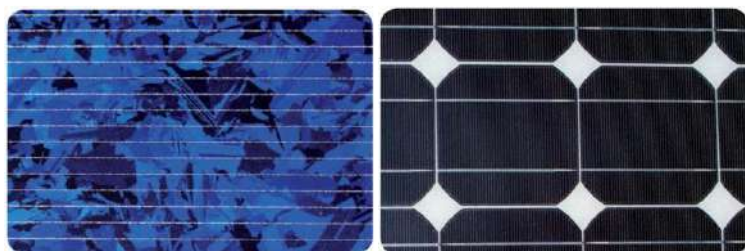
Figure 17 : illustration des deux technologies existantes : Gauche : cellules en silicium cristallin / Droite : cellules en mono cristallin
