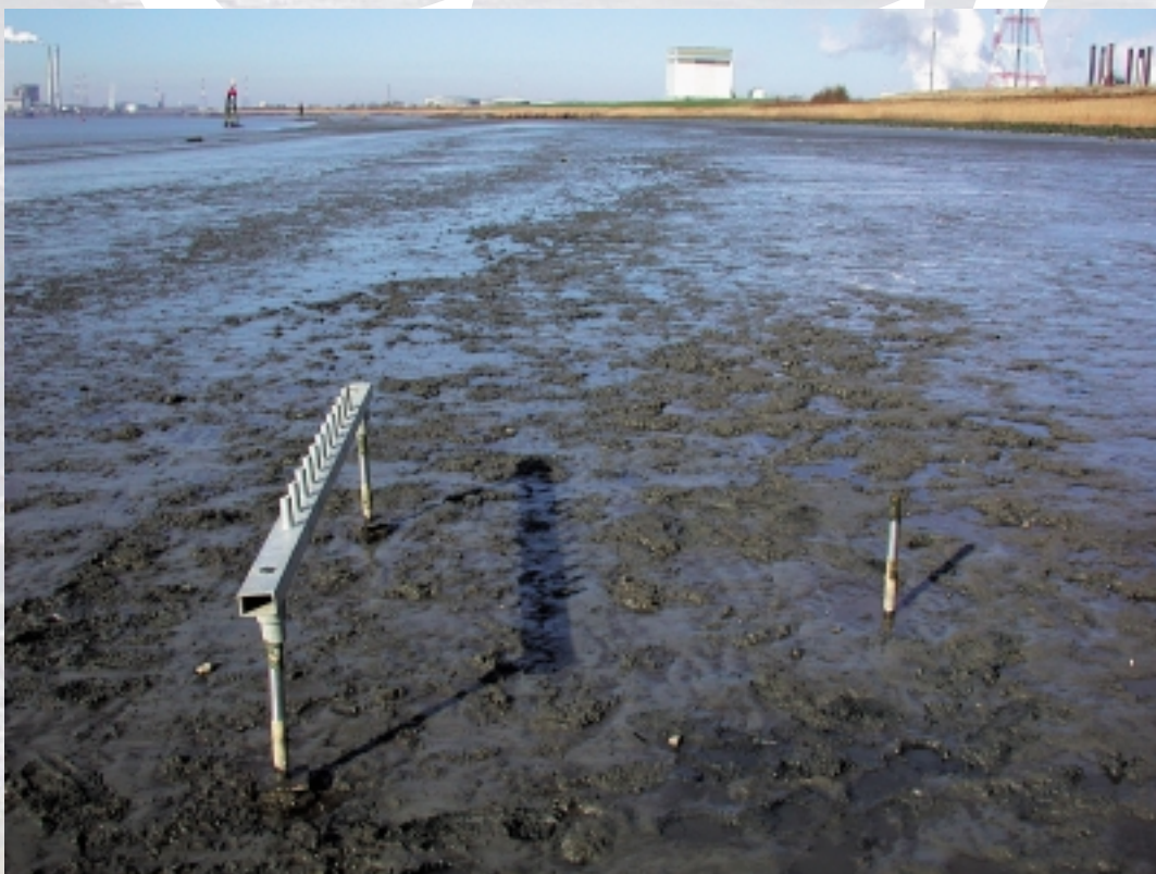
Sedimentatie-erosieprocessen worden opgevolgd aan de hand van sedimentatie-erosieplots. Elke plot bestaat uit drie buizen die in driehoeksvorm worden verankerd in het slik. Door middel van een meetrij worden telkens twee buizen met elkaar verbonden en wordt met behulp van een meter de afstand tot het slik opgemeten. De foto toont de drie buizen waarvan er twee verbonden zijn met een meetrij.
