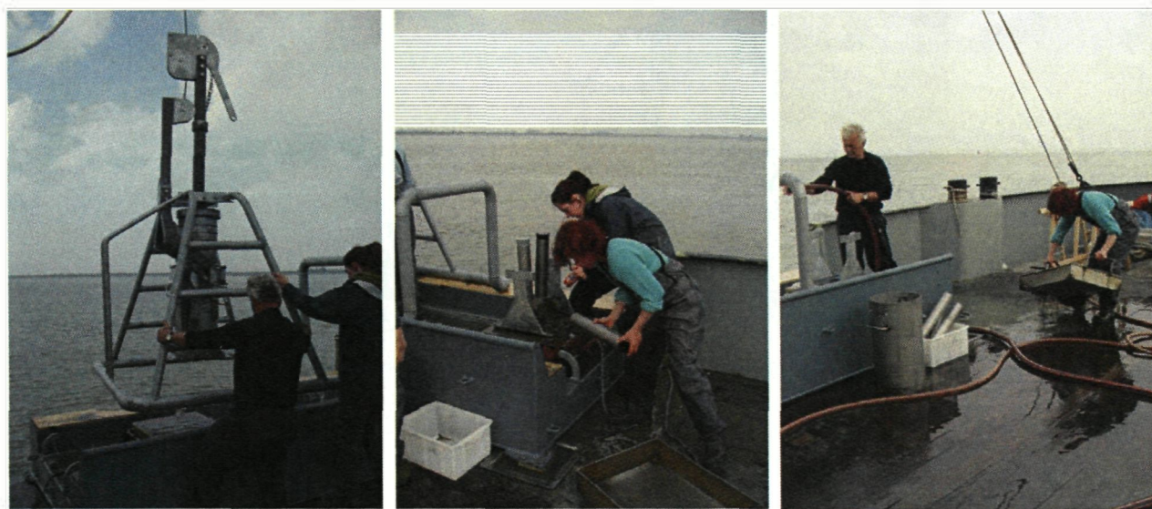
Figuur 5. Monsternamen met box corer (foto links), nemen van subcores voor macrobenthos en sediment (foto midden) en zeven van de subcores voor macrobenthos (foto rechts).
