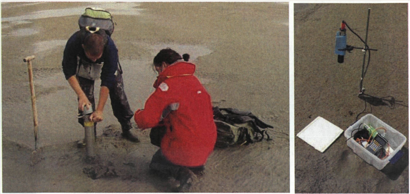
Figuur 9. Bemonstering van het macrobenthos (links) en spectrale meting van het sediment (rechts).
