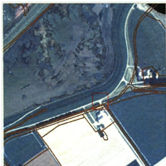
Figuur 22. Voorbeeld van de Smile correctie, toegepast op vluchtlijn 3. De bovenliggende referentie data werd aangeleverd door NIOO-KNAW.
