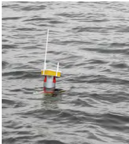
Obr. 5. Plovák s osazenou GPS stanicí. Měření proudění v nádrži Fláje 9/2008
