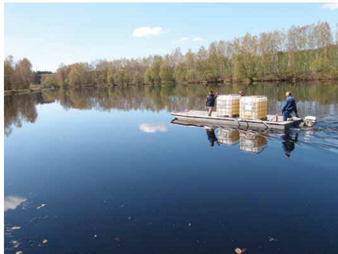
Obr. 3. Aplikace dusičnanu vápenatého kapalného – dávkování do BR I. Foto: Archiv Povodí Vltavy, státní podnik
