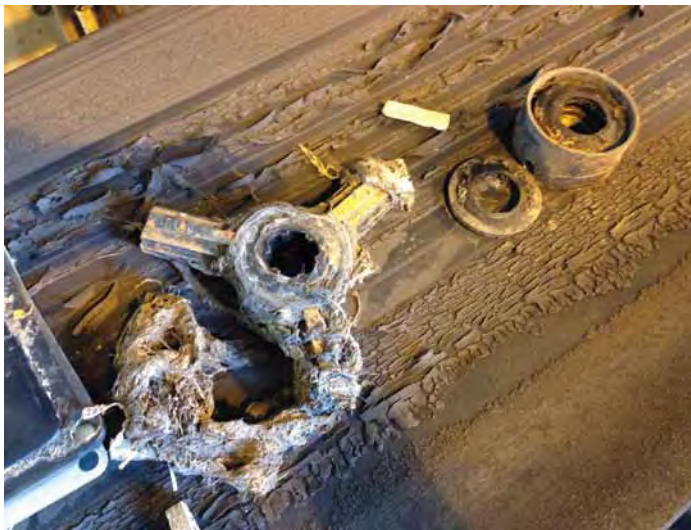
Obr. 2. Poškozené součásti macerátoru
