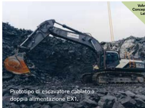
Prototipo di escavatore cablato a doppia alimentazione EX1.
