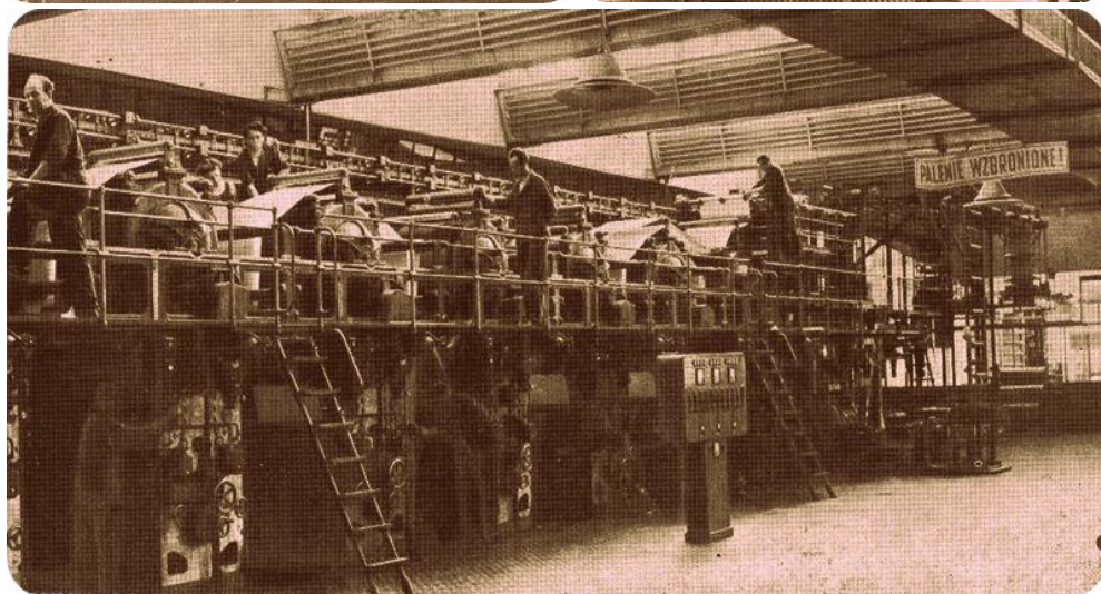
Oddział galwano - miejsce przygotowania form wkłesłodrukowych Wielokolorowa wkłesłodrukowa maszyna rolowa w montażu Z takich maszyn idą w świat wielobarwne czasopisma
