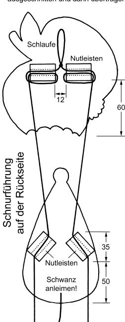
Säge die angezeichneten Teile mit dem Laubsägebogen aus und schleife die Sägestellen mit Schleifpapier nach.
