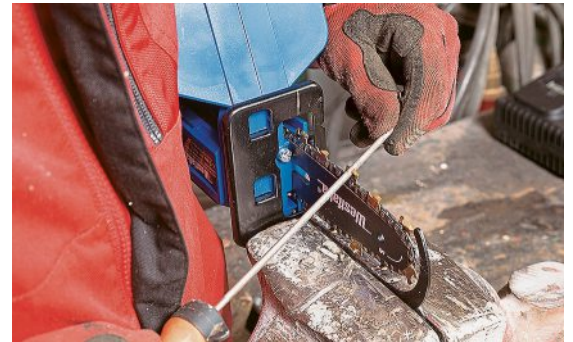
Für das Schärfen der mitgelieferten Titan-Sägekette ist eine 4-mm-Rundfeile erforderlich.
