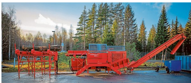
Der Hakki Pilke 55 Pro verfügt unter anderem über eine automatische Maschinenschmierung. Sie vermindert den Wartungsaufwand erheblich.
