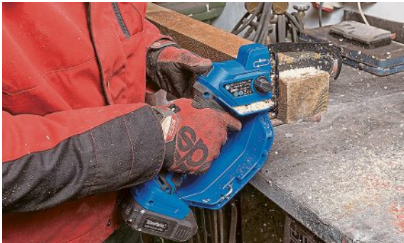
Start mit doppelter Sicherheitsschaltung: Erst den oberen, dann den unteren Knopf am Griff drücken.
