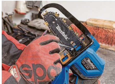
Die Stellschraube verschiebt das Schwert und spannt dadurch die Kette.
