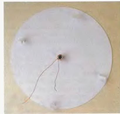
Obr. 14. Cievku prilepte na papierový kotúč s nôžkami
