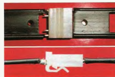
Obr. 4. Spojení dvou úseků symetrického vedení pomocí konektorů typu PHU6 a PUL6, do kterých jsou zapájeny pocínované vodiče. Pásek provlečený otvory v dielektriku eliminuje namáhání páječných spojů
