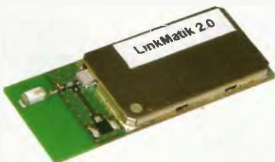
Modul LinkMatik se vyrábí ve dvou provedeních, s „nožičkami“ k zasunutí do soklu DIL a v miniaturním provedení k připojení
