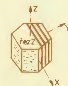
Obr. 8. Způsob řezání destiček řezu Y ze špalíčku řezu Z
