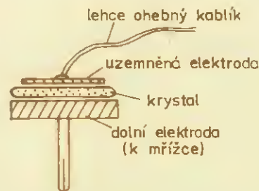
Obr. 7. Úprava elektrod pro zkoušení výbrusů v aktivním zapojení
