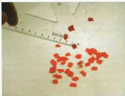
Obr. 10. Predmety s rozdielnym elektrickým potenciálom sa priťahujú
