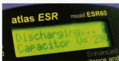
Měřicí přístroj Atlas ESR si sám vybije měřený kondenzátor
