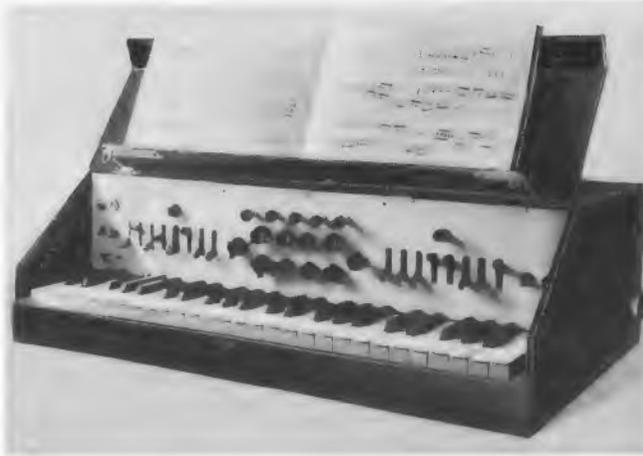
Bild 23. Das kleine Musterinstrument in Form einer transportablen Kleinorgel. Das Gerät befindet sich zur Zeit im Besitz von Herrn Dr. J. Pluhatsch, Darmstadt
