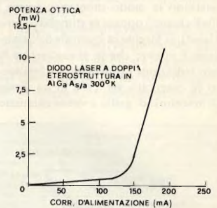
Fig. 13-a - Caratteristica del diodo laser che permette di modulare il fascio ottico.
