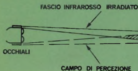
Fig. 2 - Triangolazione ottica dell'ostacolo.
