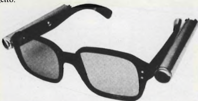
Prototipo rivelatore di ostacoli per non-vedenti, montato su di un normale paio di occhiali.
