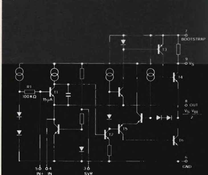
Fig. 2 - Schema elettrico semplificato di una delle due sezioni.
