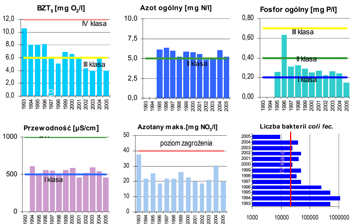
Wykres 57. Przebieg zmian wybranych wskaźników zanieczyszczeń w rzece Nysie Łużyckiej w przekroju Pieńsk-Deschka (km 135,0) w latach 1993-2005
