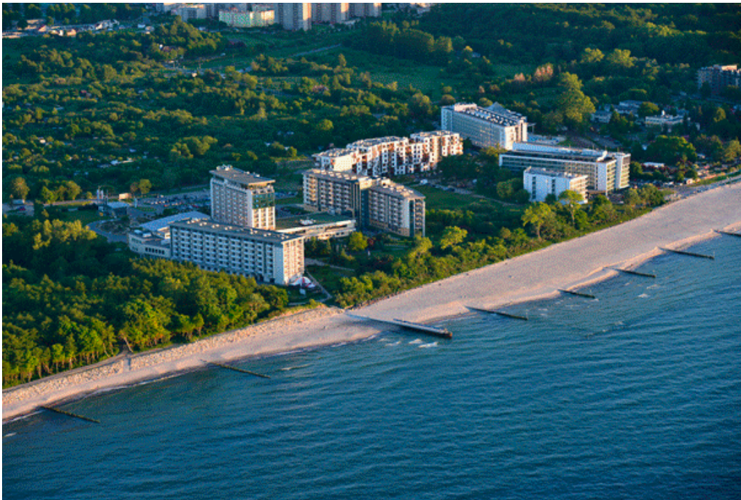
Fot. 24. Plaża w Kołobrzegu po refulacji ma 2,4 m wysokości. Podczas sztormu woda wdziera się na 3,5 m wysokości, te hotele zagrożone są podtopieniem. Coraz więcej takich inwestycji powstaje blisko brzegu, a w następstwie wymaga się podjęcia działań na rzecz ochrony mienia
