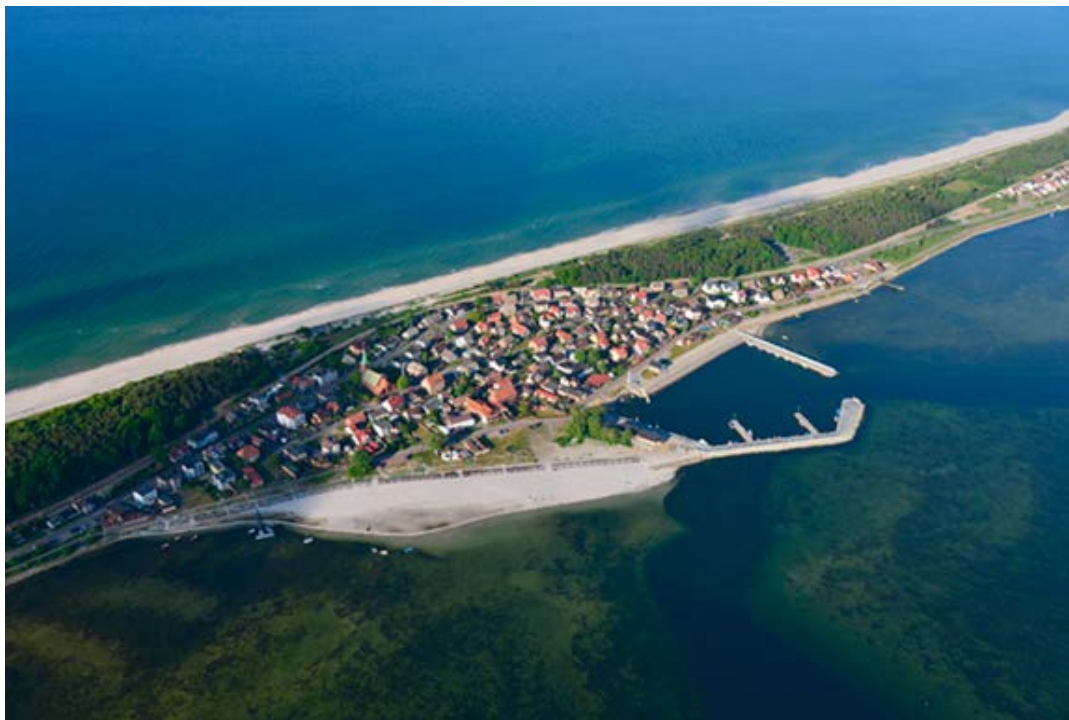
Fot. 7. Wąska część Półwyspu Helskiego w rejonie Juraty. Widoczne falochrony portowe na Zalewie Puckim i sztucznie refulowana plaża
