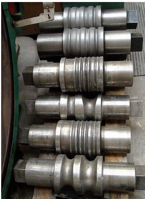
Obr. 2 Válce pro válcování - kalibrované
