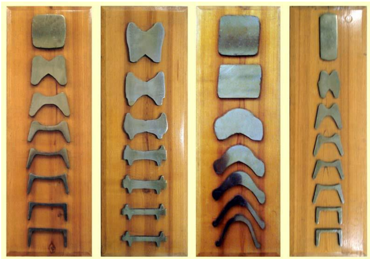
Obr. 5 Válkování profilů – řezy profilů byly odebrány po každém průchodu tyče mezi dvěma válci válcovací stolice
