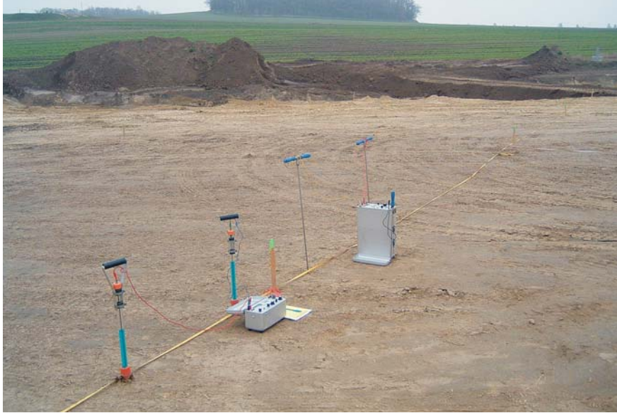
Induzierte Polarisation (Profilmessung für Tonvorkommen). Induced polarisation (profiling for clay deposits).
