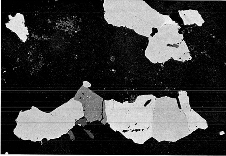
Abb. 2: Vererzung Lehnermühle. Magnetkies (lichtgrau, durch Reflexionspleochroismus verschiedene Töne) ist mit Zinkblende (mittelgrau, links unterhalb Bildmitte) und kleinen Graphitaggregaten (licht- bis dunkelgrau, Reflexionspleochroismus!) sowie mit etwas Kupferkies (Spur heller als Magnetkies, rechte obere Bildhälfte) verwachsen. Kupferkies dringt entlang Korngrenzen in Magnetkiesverwachsungen ein. Die Zinkblende zeigt schwache Magnetkiesentmischung. Randlich am Magnetkies findet sich etwas Titanit (dunkelgrau), in der Gangart Graphit (besonders linke obere Bildhälfte). Anschliff, Vergr.: 85×.
