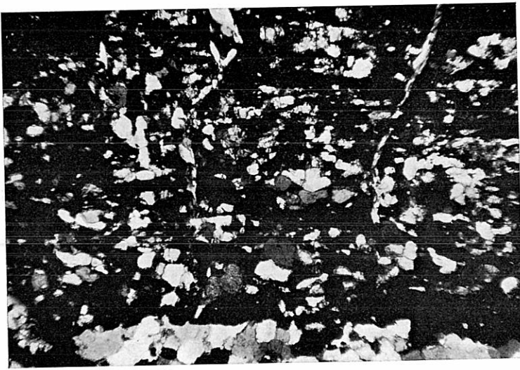
Abb. 7: Dörflerbachgraben, Vorau. Ausschnitt aus Granat, der verdrängend in eine Lage von rekristallisiertem sideritischem Karbonat (unterer Bildrand) eindringt. Es ist wieder zu erkennen, wie Granat entlang Korngrenzen das Karbonat aufzehrt und Intergranularfilme und die Karbonatkörner bildet. Entlang »(ac-)Rissen« wird Granat von Chlorit verdrängt. Neben Granat und Karbonat tritt etwas Erz auf.
