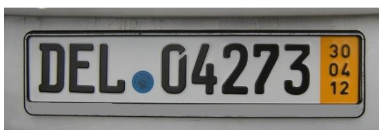
Fot. Tymczasowa niemiecka tablica rejestracyjna – ważna pięć dni od dnia wydania. Na żółtym pasku z prawej data wygaśnięcia ważności.
