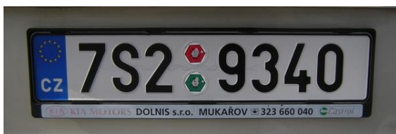
Fot. Czeska tylna tablica rejestracyjna. Wyraźnie widoczne dwie naklejki oznaczające, że pojazd przeszedł okresowe badanie techniczne i badanie spalin.
