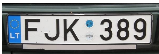
Fot. Litewska tablica rejestracyjna. Wyraźnie widoczna naklejka potwierdzająca przejście przez pojazd kontroli technicznej (na górze) oraz naklejka legalizacyjna z wydrukowanym na niej numerem rejestracyjnym (na dole).
