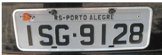
Fot. Standardowa brazylijska tablica rejestracyjna wg wzoru stosowanego do 2014 roku. Wyraźnie widoczna metalowa plomba legalizacyjna łącząca główną część tablicy z wstawką wskazującą na stan, w którym pojazd jest zarejestrowany.
