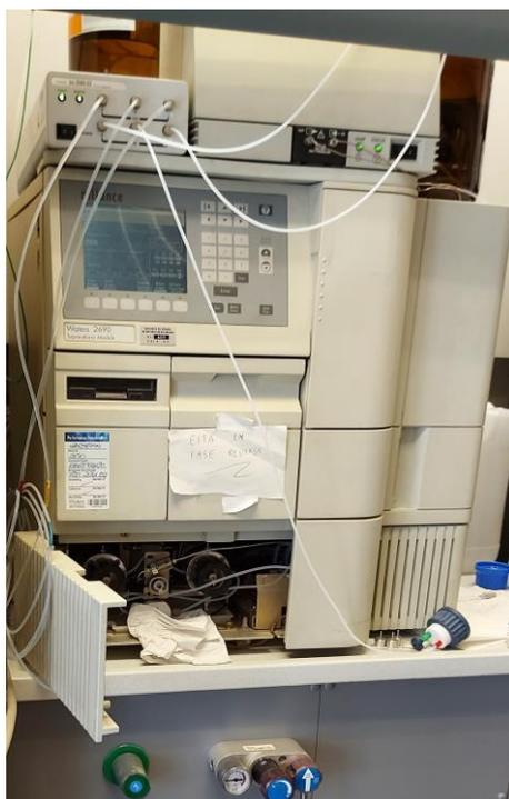
**Figura 10:** HPLC modelo Waters 2690 con desgasificador JASCO DG-2080-53 3-Line Degasser y detector Waters 2996 Photodiode Array
