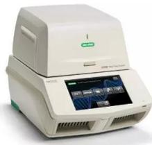
Este instrumento de RT-PCR de seis canales (cinco colores y un canal FRET) combina tecnología óptica avanzada con un control de temperatura preciso. La tecnología óptica avanzada incluye excitación mediante 6 LED filtrados y detección por fotodiodos (94).
