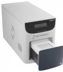
El instrumento de RT-PCR DTLite se utiliza para el análisis cualitativo y cuantitativo de muestras de ADN y ARN. La detección simultánea de una señal fluorescente en todos los pocillos de la matriz proporciona uniformidad de detección y alta velocidad del instrumento (86). El método de detección óptica se basa también en la tecnología Peltier.
