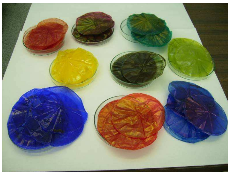
Figura 43: Membranas de TAC obtenidas en este proyecto, con diferentes proporciones de plastificante (de 0 a 200%) y colorantes.
