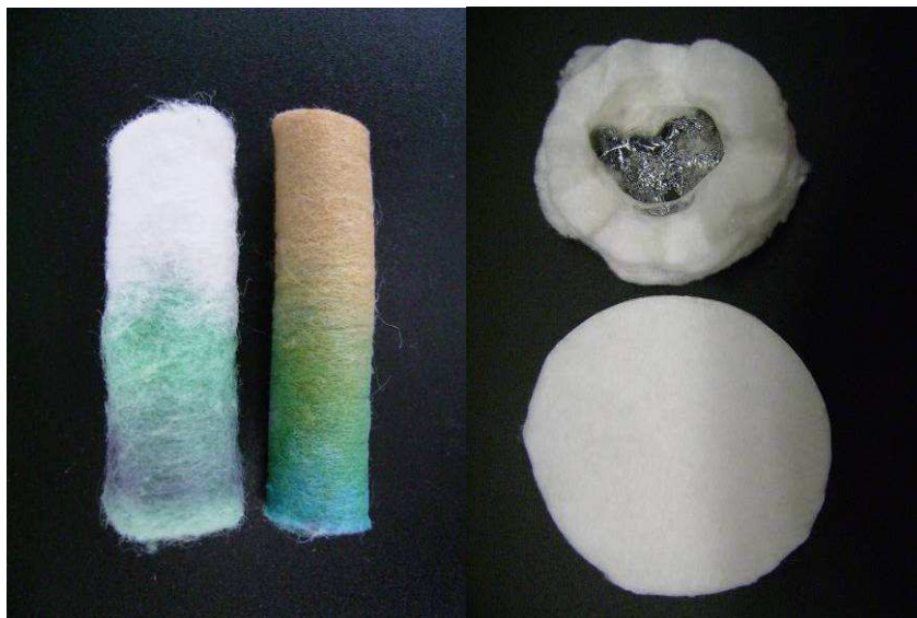
Figura 40: a) Dos pequeños rollos (1x6 cm) de algodón (derecha) y TAC (izquierda, método tolueno/I 2 , una etapa) empleados para filtrar una disolución acuosa de colorantes. b) efecto causado por una gota de diclorometano sobre dos discos de algodón. El de arriba se disuelve (acetilado) (tolueno/I 2 , una etapa). El de debajo no resulta afectado al no haber sido acetilado.
