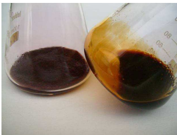
Figura 29: Acetilación con \text{Ac}_2\text{O} / \text{I}_2 (4 ml / 50 mg) de dos discos de algodón iguales (0.5 g) a 50^\circ\text{C} . En el matraz de la derecha se añadió 1ml de ácido acético.
