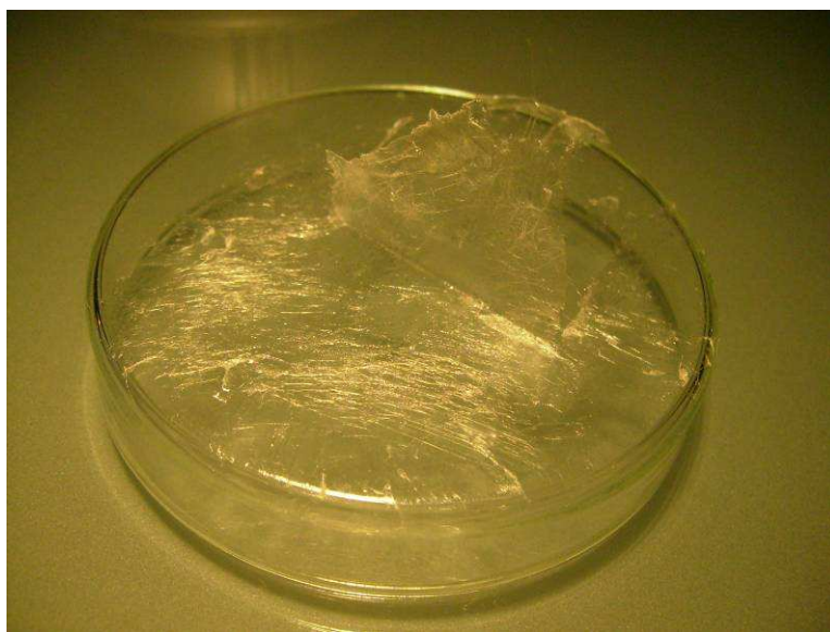
Figura 44: Película (0.05 mm) de TAC en TFA que presenta tendencia a fibrilar, característica de los polímeros cristal líquido.
