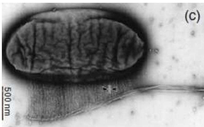
Figura 22: Formación de una fibra de celulosa por agregación de numerosas microfibrilas
