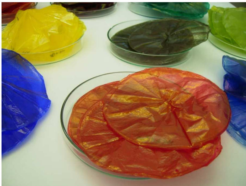
Figura 3: Películas de triacetato de celulosa 0.03mm de espesor y 12cm de diámetro
