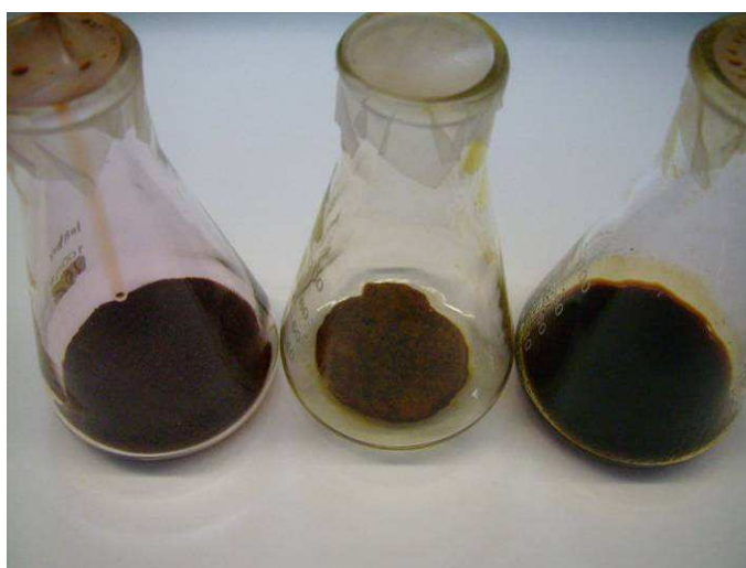
Figura 38: (De izquierda a derecha) a) un disco de algodón sin activar tratado con la mezcla ( \text{I}_2 + \text{Ac}_2\text{O} ), a t=0 , b) después de 24h a 50^\circ\text{C} y c) un disco activado (con \text{AcOH} 90%/ \text{AcOH} glacial) tratado con ( \text{I}_2 + \text{Ac}_2\text{O} ), después de 24h a 50^\circ\text{C} .
