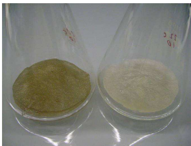
Figura 41: A la derecha disco de algodón recién tratado con 10 mL de mezcla acetilante [Tolueno 45%/Ac 2 O 45%/AcOH 8%/agua 2%]. A la izquierda, otro disco tratado igual, pero sin el 2% de agua.
