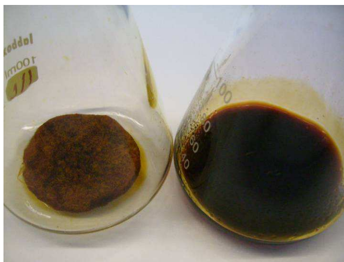
Figura 39: Muestra 1 a t = 12h en el matraz de la derecha, casi completamente disuelta y la muestra 2 en el de la izquierda a t = 24h .
