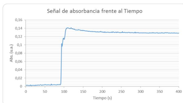
Figura 14: Variación de la señal de absorbancia frente al tiempo para una concentración de AR de  $5 \cdot 10^{-6} M$ , 2,28 U/mL de HRP y  $9,8 \cdot 10^{-7} M$  de peróxido de hidrógeno. Longitud de onda: 570 nm. Disolución amortiguada con tampon fosfatos a pH 6.
