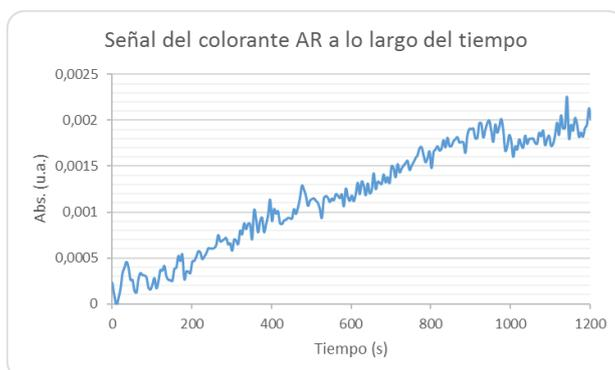
Figura 30: Variación de la señal de una disolución de  $5 \cdot 10^{-6} M$  de colorante AR en un medio tamponado con fosfatos a pH 6 expuesta a la luz y realizando medidas cada 5 segundos.
