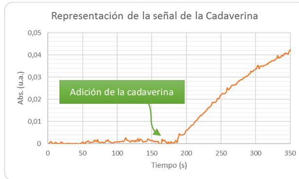
Figura 19: Variación de la señal de absorción para una concentración de DAO 3,6 U/mL, 0,2 U/mL de HRP,  $5 \cdot 10^{-6}$  M de AR y  $1,16 \cdot 10^{-6}$  M de cadaverina, todo ello tamponado con disolución fosfatos a pH 6.
