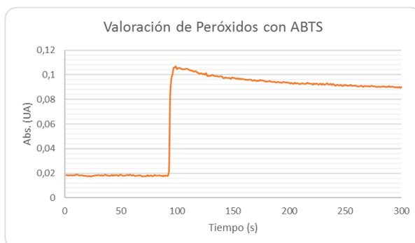
Figura 10: Representación de la variación de la señal de absorbancia frente al tiempo para una valoración con  $4,29 \cdot 10^{-7}$  M de H<sub>2</sub>O<sub>2</sub>, 2,5 U/mL, y disolución de tampon de fosfatos a pH 6.
