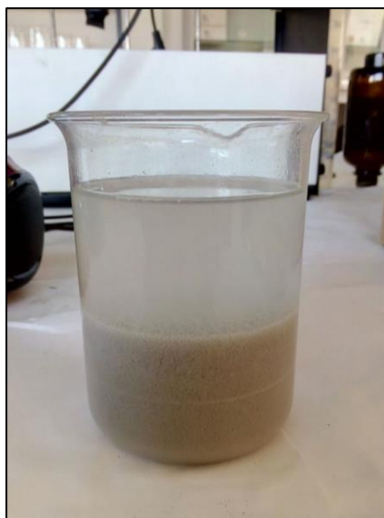
Figura 18. Ejemplo de la etapa de decantación.
