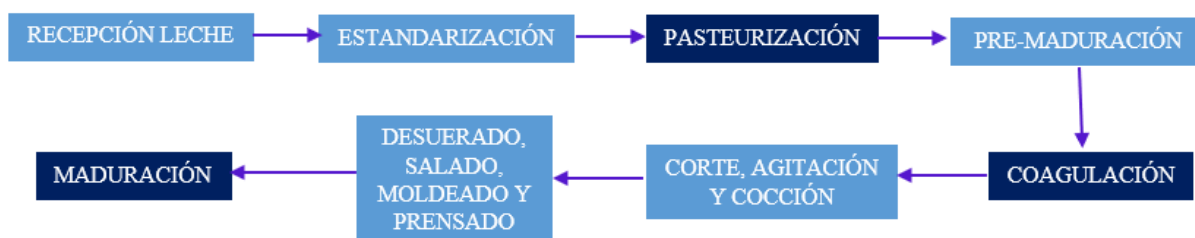
Figura 8. Diagrama de flujo del proceso de elaboración del queso (en azul oscuro las etapas en las que intervienen el uso de enzimas)
