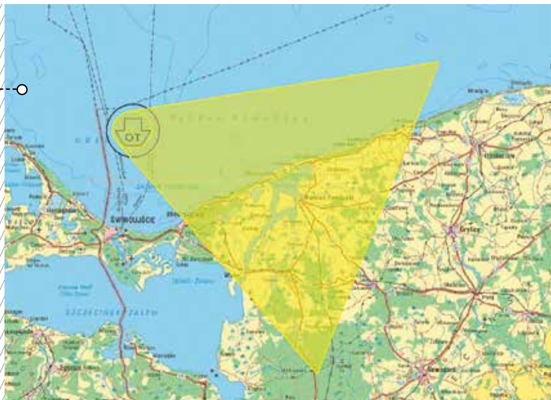
Rys. 5. Prognoza zasięgu strefy skażeń w razie wycieku chloru z ładowni statku
