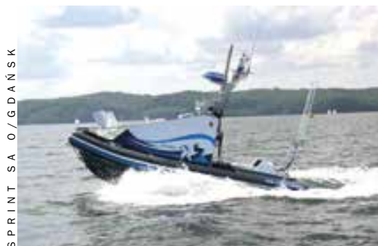
Fot. 1. Bezzałogowy pojazd nawodny Edredon podczas wykonywania zadań
